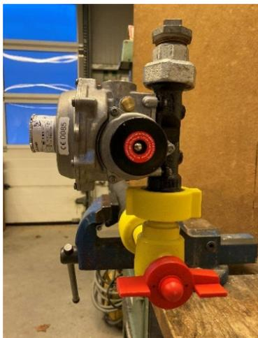
**Achtung:** Das GDR darf bei der Belastungs- und Dichtheitsprüfung der Gasinstallation **nicht** mit einbezogen werden (Steckscheibe setzen)!
